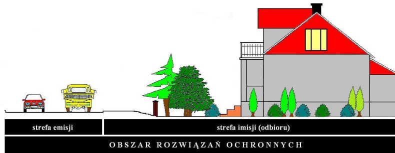
Ryc. 12 Strefy emisji i imisji hałasu oraz obszar rozwiązań ochronnych w uniwersalnym podejściu do ochrony przed hałasem drogowym 42
